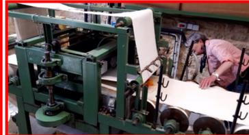
La matière obtenue est ensuite répartie en couches fines qui sont assemblées en plusieurs épaisseurs puis qui sont pressées jusqu'à obtenir l'épaisseur désirée. On peut alors incorporer des éléments de décors, eux-mêmes constitués de bandes ou de plaques de feutre qui seront imbriquées lors des pressions suivantes.
